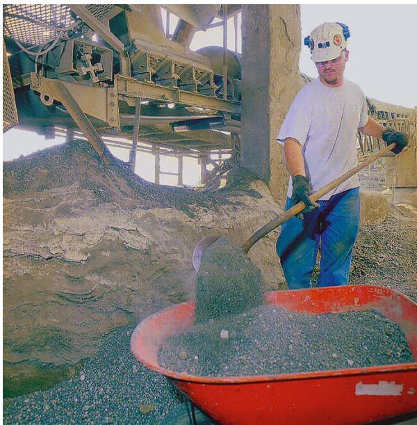
Dépôts de matières en dessous du convoyeur
